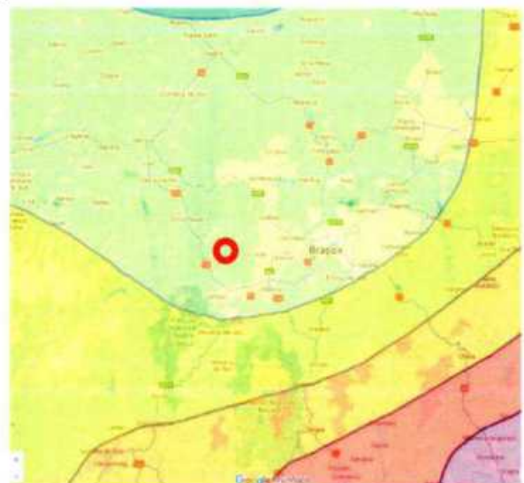
Fig. 1. România – Zonarea valorilor de vârf ale accelerației terenului pentru proiectare a_g cu IMR=225 ani și 20% probabilitate de depășire în 50 de ani
